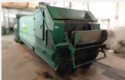
垃圾斗內置壓縮系統，垃圾房無需設置其他固定裝置
